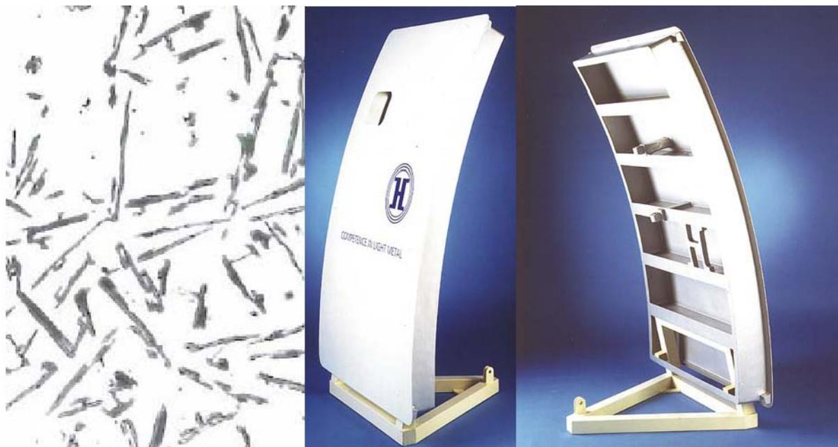
**Abbildung 12:** Aluminium: links: Gefüge einer AlSi-Legierung [2]; rechts: einteilige Airbus-Passagiertür aus einer Aluminiumgusslegierung (Honsel, Meschede)
