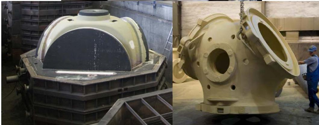
**Abbildung 7:** oben: kleine Kerne, unten: Großgussform mit Kern und fertiges Gussteil (Meuselwitz Guss, Meuselwitz)
