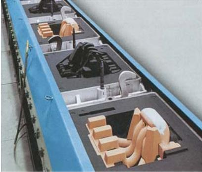
**Abbildung 2:** Formhälften mit eingelegten Kernen in einer automatischen Formanlage
