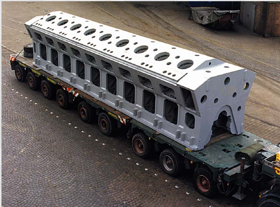
Motorblock, Gusseisen Gewicht: 83 t
