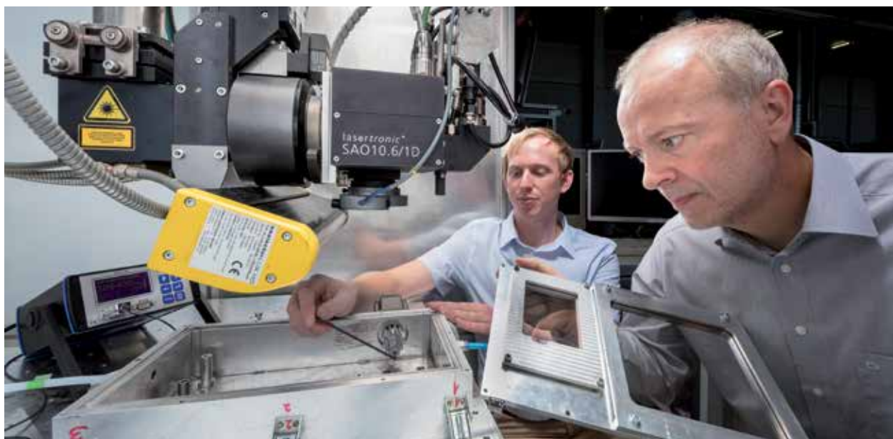
Laser statt Lappen: Harald Riegel (rechts), Leiter des Laser-Applikationszentrums, und Doktorand Simon Ruck reinigen im Labor die Oberfläche gedruckter Bauteile. Dazu nutzen die beiden Aalener Forscher das Licht eines Lasers.
