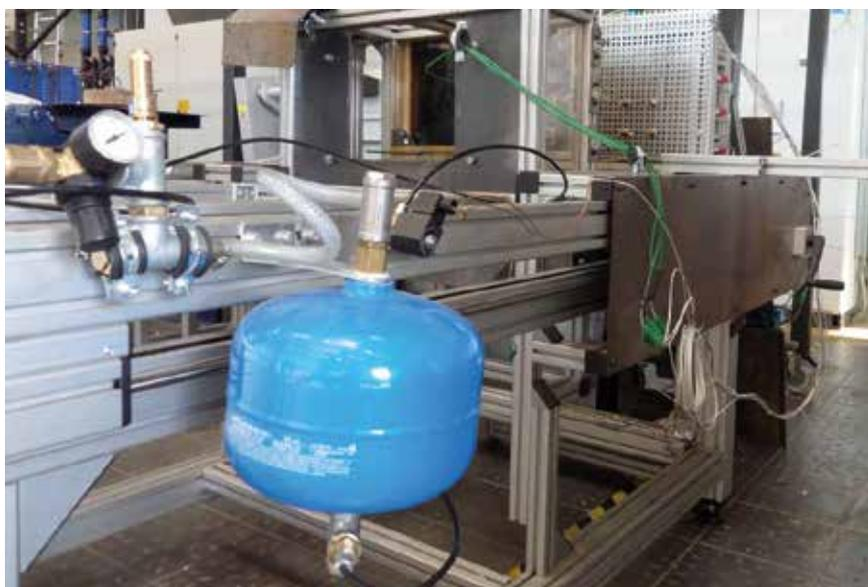
**Aufbau des Kokillenprüfstands zur Funktionsprüfung des Sensors zur Erfassung von Verbrennungsprodukten beim Gießen mit Sprühvorrichtung, Messtechnik und Mechanik zum Öffnen und Schließen; blau: Trennmittelbehälter.**
