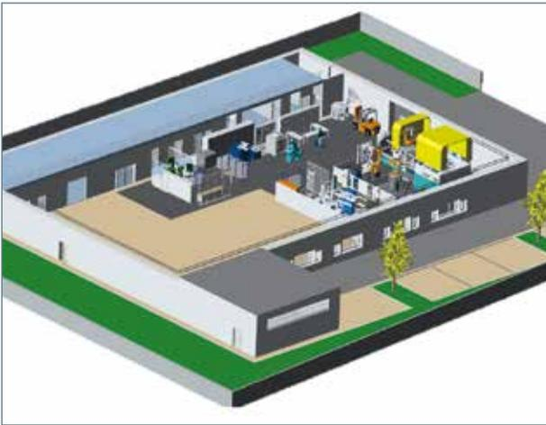
Hallenlayout „Gießtechnikum Metakushalle“ mit der neu hinzugewonnenen Versuchsfläche für das GTK (brauner Bereich).
