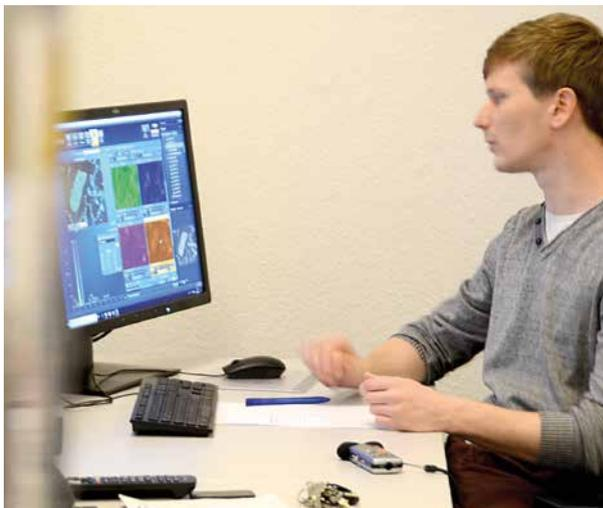
**Roland Kalwis ist Technischer Angestellter am Institut in Duisburg. Mit dem neuen Rasterelektronenmikroskop untersucht er gerade Magnesiumlegierungen. Die Bilder zeigen die Elementverteilung von z. B. Sauerstoff, Kalzium und Magnesium.**
