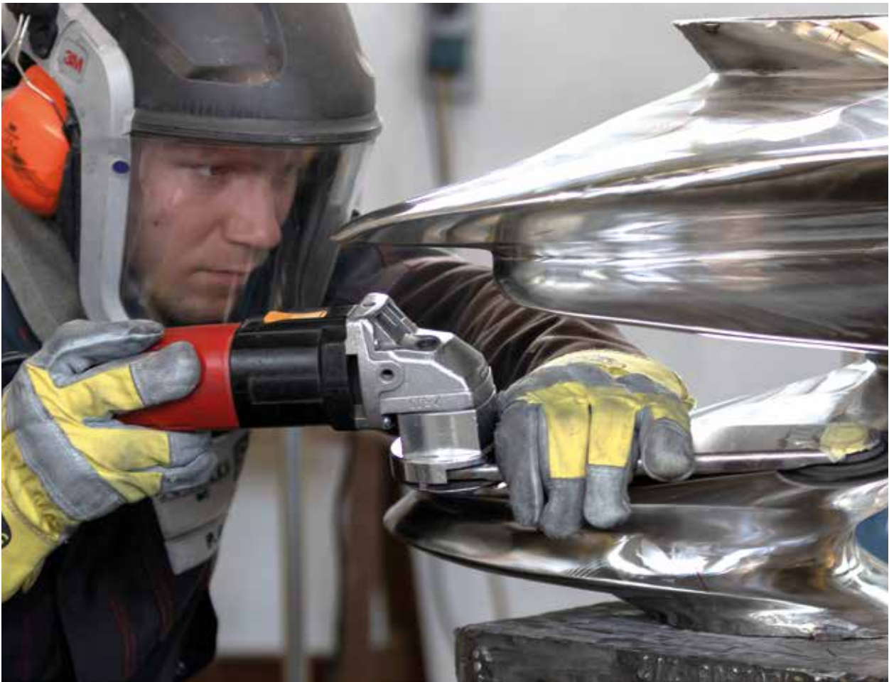
In Handarbeit wird der Edelstahl auf Hochglanz poliert. Bei komplexen Skulpturen können mehrere Hundert Stunden Polierarbeit nötig sein.
